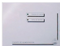
Font d'alimentació estabilitzada 12 Vcc/6A
